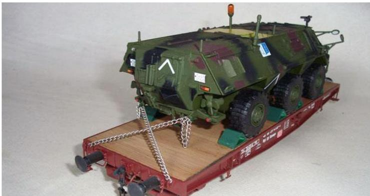
Jedes Stück wird über die Stirnhaken des Wagens geschoben und mit ein Drahtstück befestigt an ein Fahrzeughaken am Hinterseite des Panzers.
