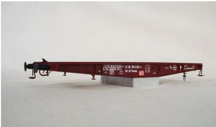
Die beiden Drehgestelle werden mit Rädern bestückt und montiert, wie die Puffer und die Schraubkupplungen.
